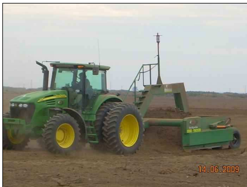
Fig. 1. Tractor agrícola amb equip d'anivellació làser.
